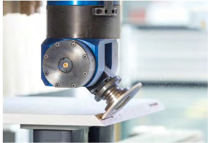
Vollautomatisches und präzises Nutfräsen mit Flex5+C
