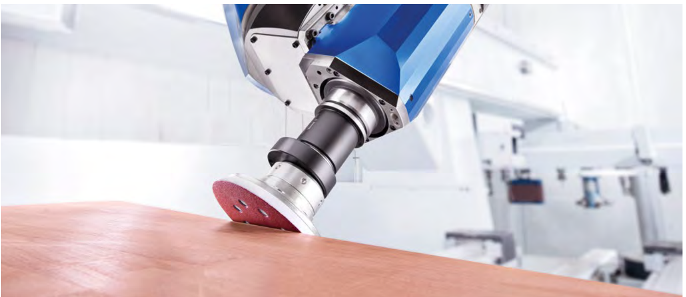
Fasenschleifen an einer Treppenstufe
