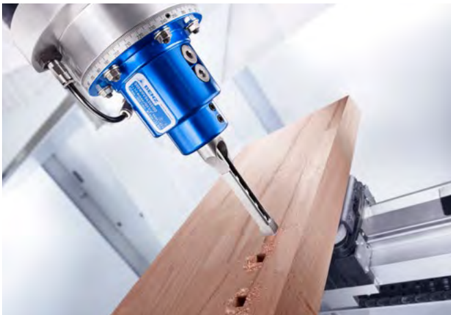
Staketenlochbohrungen bei Treppenstufen
